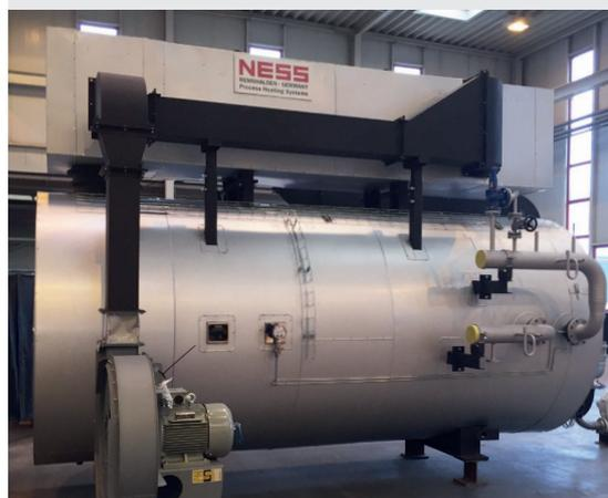
**Avec préchauffeur d'air de combustion**
