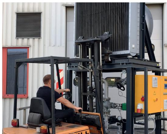
Двухкомпонентный салазки для вилочного погрузчика
