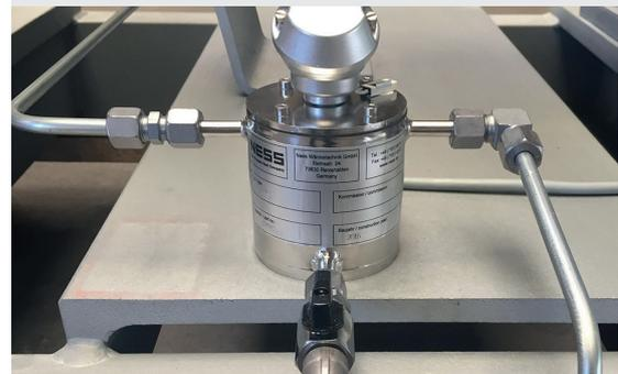
Angeschlossene Leckage-Überwachung (NPCL)
