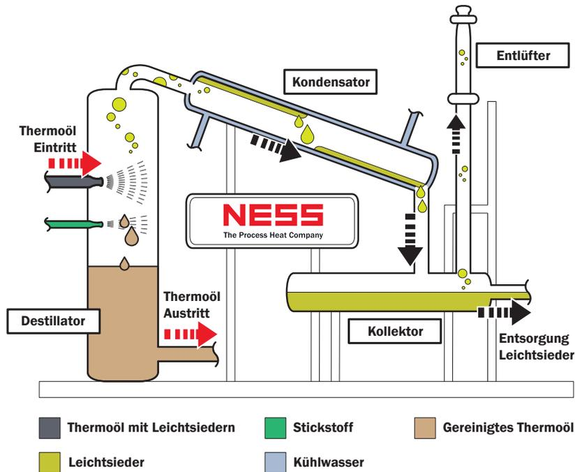
Leichtsiederentfernung für eine sicherere und effektivere Anlage
